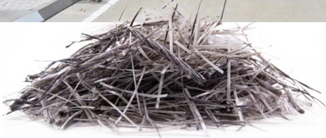
Makrofasern optimieren die mechanische Tragfähigkeit des Betons und minimieren die Bildung von Schwindrissen. Da synthetische Fasern keine Korrosionen bilden, wird die Lebensdauer von Betonen auch in maritimen Umgebungen deutlich verlängert.
